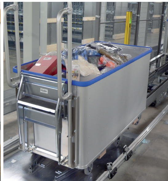
Kommissionierwagen in der Flurförderanlage
