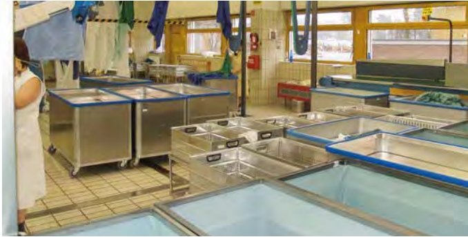
Einsatz von Federbodenwagen und Körben in der Wäscherei
