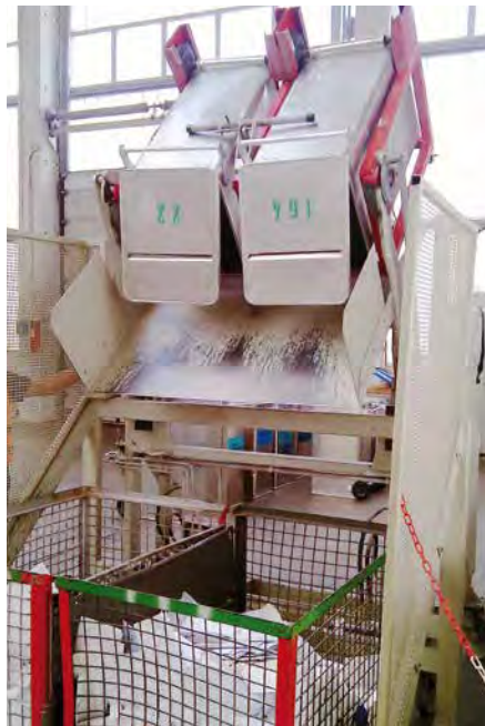
Leerung der Tonnen mit einer Hub-Kippvorrichtung
